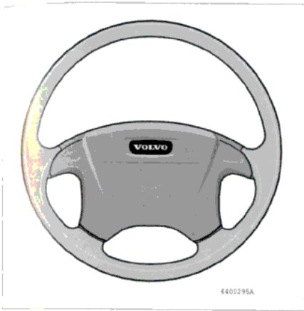
Poduszka powietrzna zamontowana jest we wkładce kierownicy i oznaczona „SRS”
