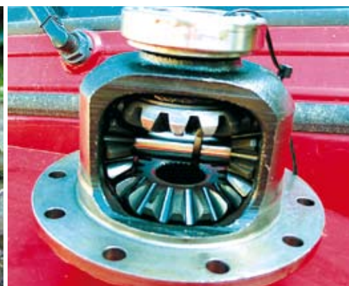
▲ Stożkowy mechanizm różnicowy – w koszu widoczne są dwa satelity
