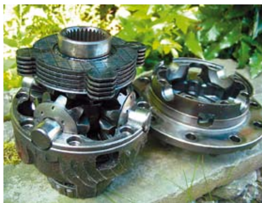
▲ Mechanizm różnicowy o zwiększonym tarcu wewnętrznym – widoczne cztery satelity i płytki sprzęgieł ciernych
